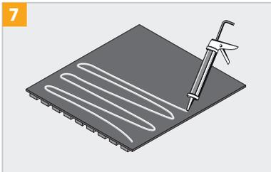
**7** Trage den Montagekleber mit einer Kartuschenpistole auf die Filzrückseite der Paneele auf.
